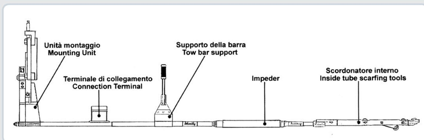
Disponibili: meccanici - idraulici e pneumatici - Available: mechanical - hydraulic e pneumatic
